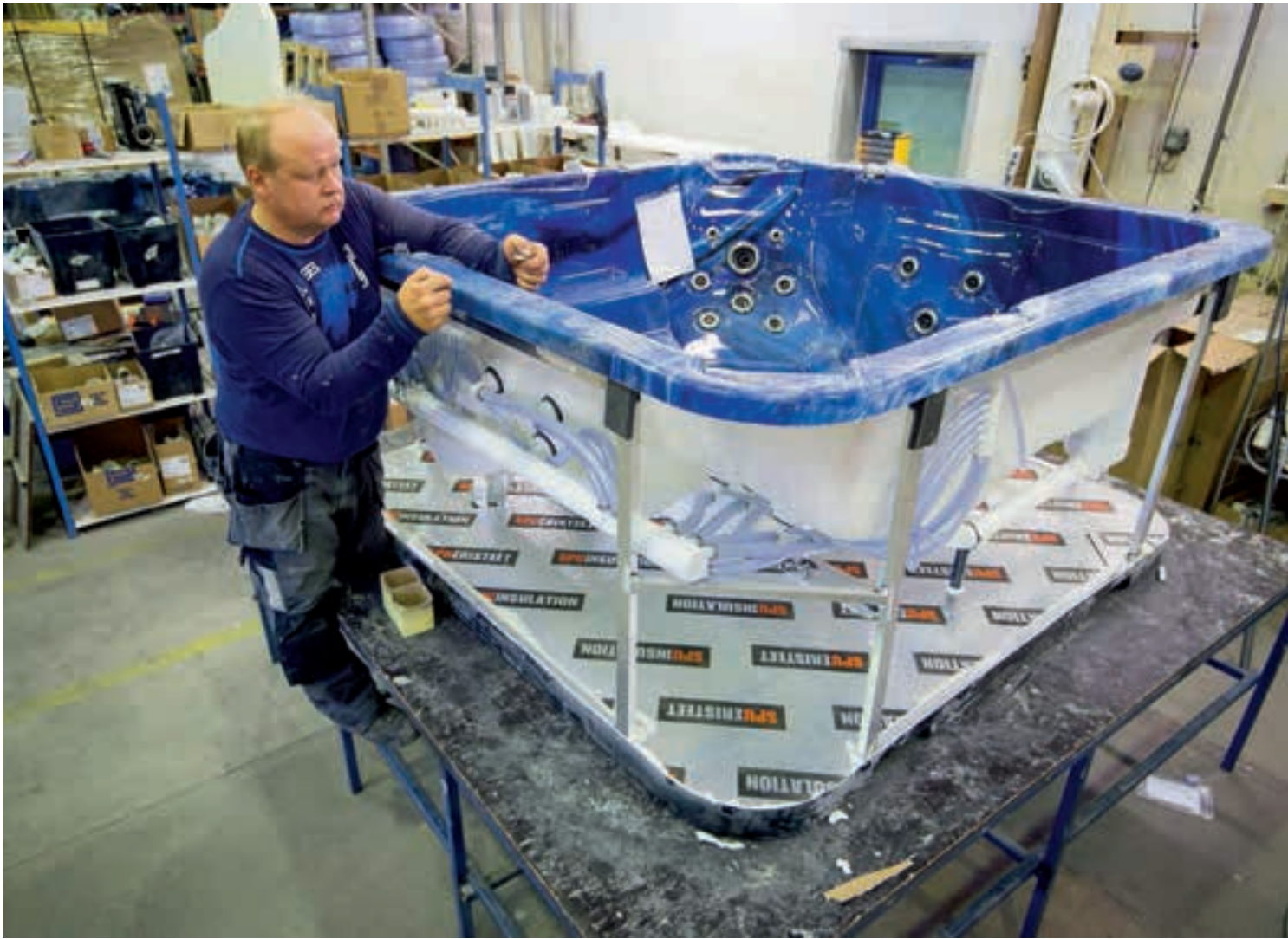
Samassa teollisuuskiinteistössä Bikeservicen kanssa toimii ulkoporealtaita valmistava tehdas. Matti Piekkala kokoaa ulkoporeallasta.
