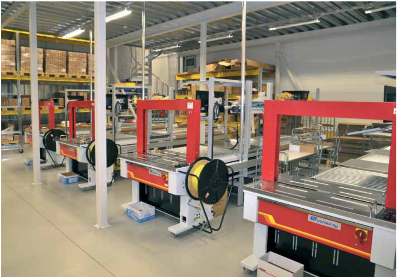
Pakkauslinjastojen yläpuolinen tila on välitasorakenteen ansiosta hyötykäytössä. Pakkauspöytiin on integroitu rullakuljettimia, vaakalaitteita, automaattinen vannekone ja muita lisälaitteita.
