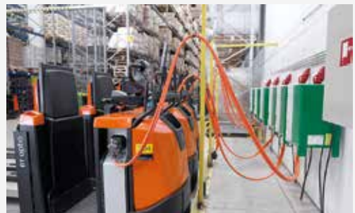
Litium-ionitrukkien lataaminen käy nopeasti ja helposti taukojen aikana – erillistä lataushuonetta ei tarvita.
