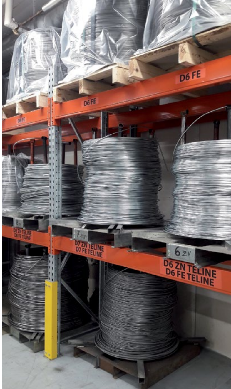
Lankakelojen säilytystä varten löydettiin Kastenin vakiohyllystöä muokkaamalla sopiva ratkaisu.
