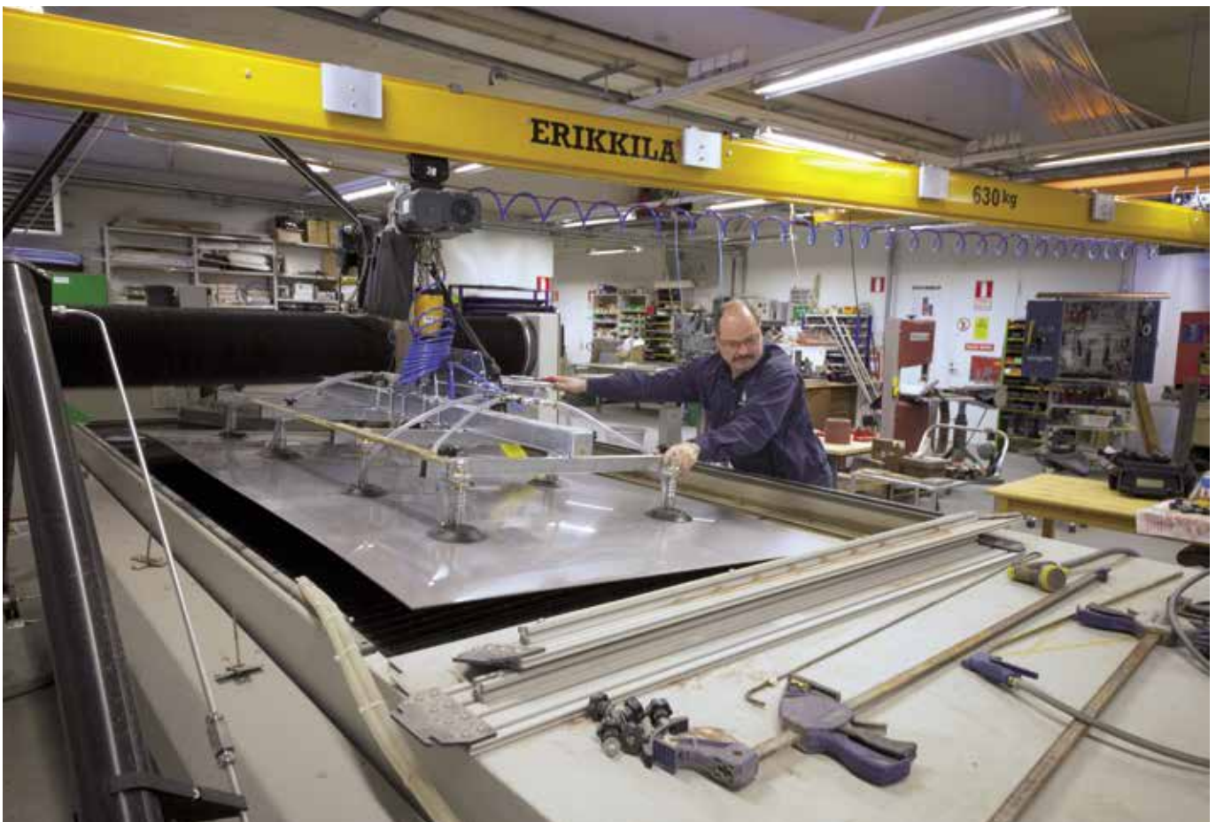
Painavien teräslevyjen nosto ja siirto on turvallista ja ergonomista.
