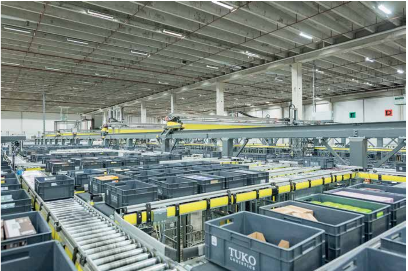
AUTOMAATTISESTI. Suomalaisen Cimcorpin toimittama keräilyautomaattijärjestelmä työskentelee lähes kokonaan ilman ihmiskäsiä.
