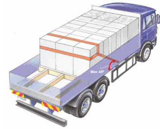
Kuva 40: Valjassidonta erillisen remmin avulla
