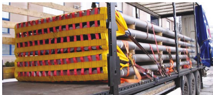
Kuva 32: Kuorman varmistaminen menosuunnassa verkon ja suorasideontan avulla
