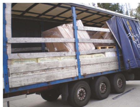
Kuva 19: Tässä tapauksessa lastin varmistaminen pelkällä kiristekalvolla ei riittänyt
