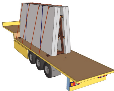
Kuva 48: Varmistaminen tuennan, elementtipukin, ympärisidonnan ja ylisidonnan yhdistelmällä
