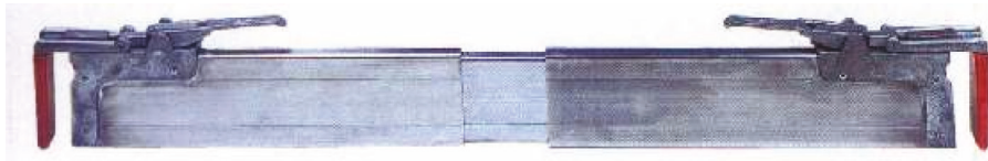
Kuva 26: Tukitanko, jonka kiinnitys sivuseiniin tai listoihin perustuu kitkaan
