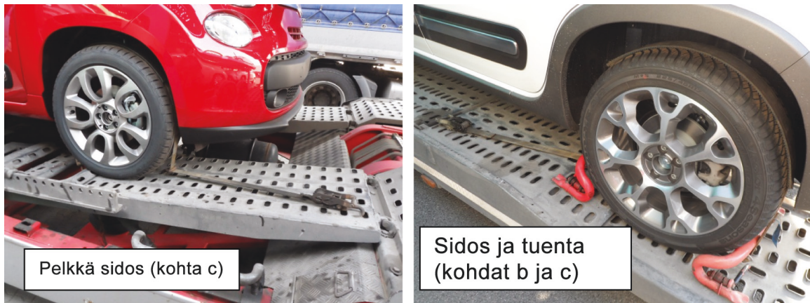
Kuva 57: Kiinnitysjärjestelyt autoja kuljetettaessa
