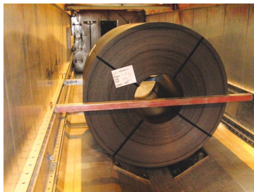
Kuva 61: Kelojen kuljettaminen erikoisrakenteisessa ajoneuvossa
